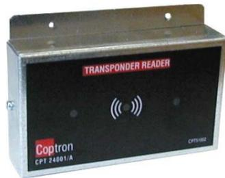
Questo dispositivo permette la lettura di transponder passivi tramite antenna posizionata sulla pistola di erogazione, inviando il dato rilevato al sistema di gestione centrale. Dispone inoltre di un ingresso per pulsante di chiamata, un pilotaggio di un semaforo rosso/verde remoto, un'uscita attuatore a relè e un indicatore locale di transponder letto.
