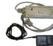
Convertitore necessario per interfacciare il terminale di piazzale CPTT2 o il controller AT22601 ai transponder reader M.R. AT29803/K (max. 8).
