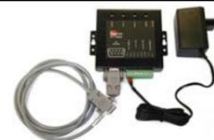
Convertitore necessario per interfacciare il controller AT22601 alle testate dei distributori.
